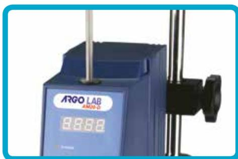
Foro di passaggio superiore per aste di agitazione
