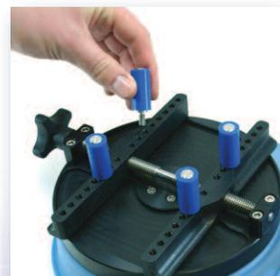
I perni di fissaggio sono facilmente regolabili per adattarsi a qualsiasi particolare.
