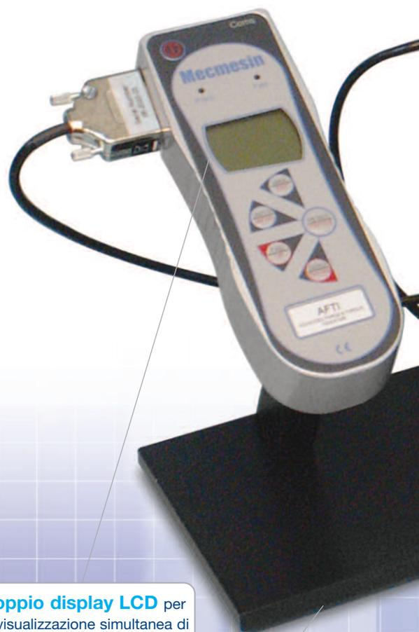
**Doppio display LCD** per la visualizzazione simultanea di forza e torsione.
