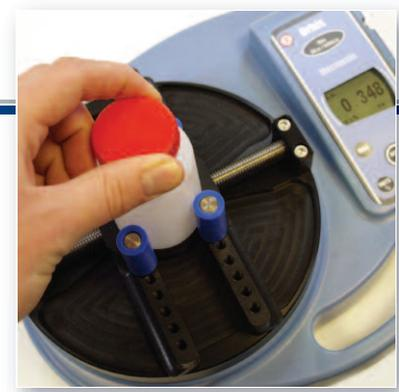
**Piastra di afferraggio**, con perni regolabili per il serraggio di particolari con svariate forme. Sagomata per la raccolta di liquidi.
