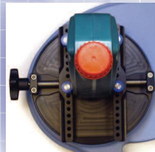
Anche i contenitori con forme anomale possono essere facilmente bloccati posizionando i perni in modo che la chiusura risulti in asse con la cella sottostante.
